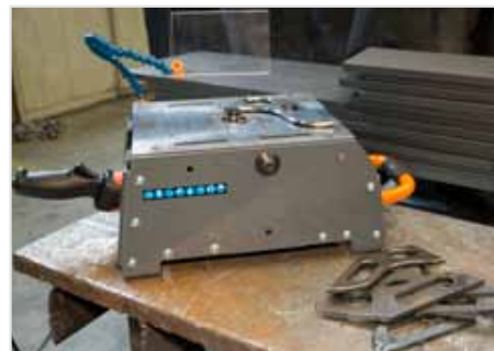
Straight edge beveling guide
